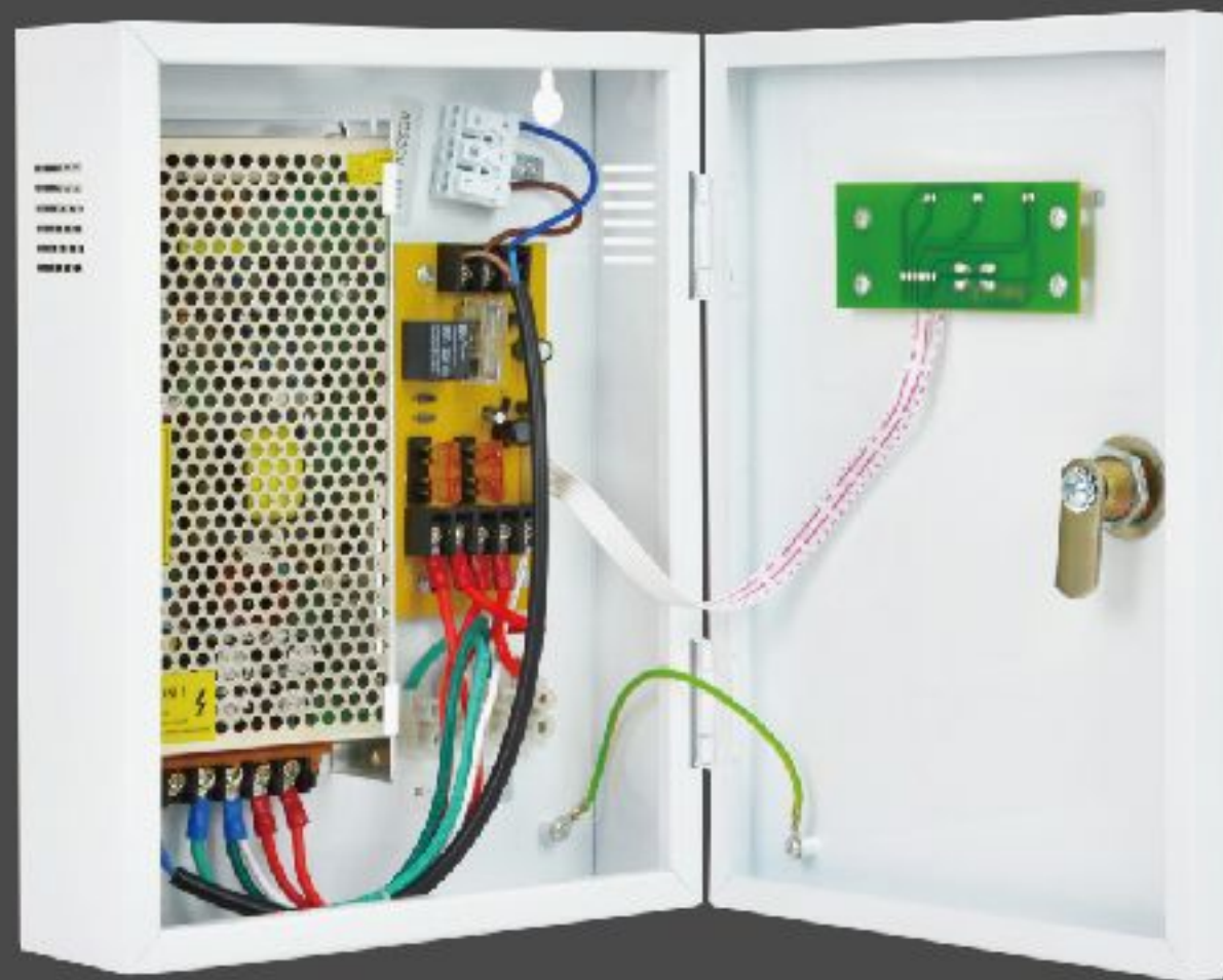
YG-PD-220 地埋灯需连接变压箱使用 此变压箱功率为75W 可以配50台我司生产的地埋 灯具使用
