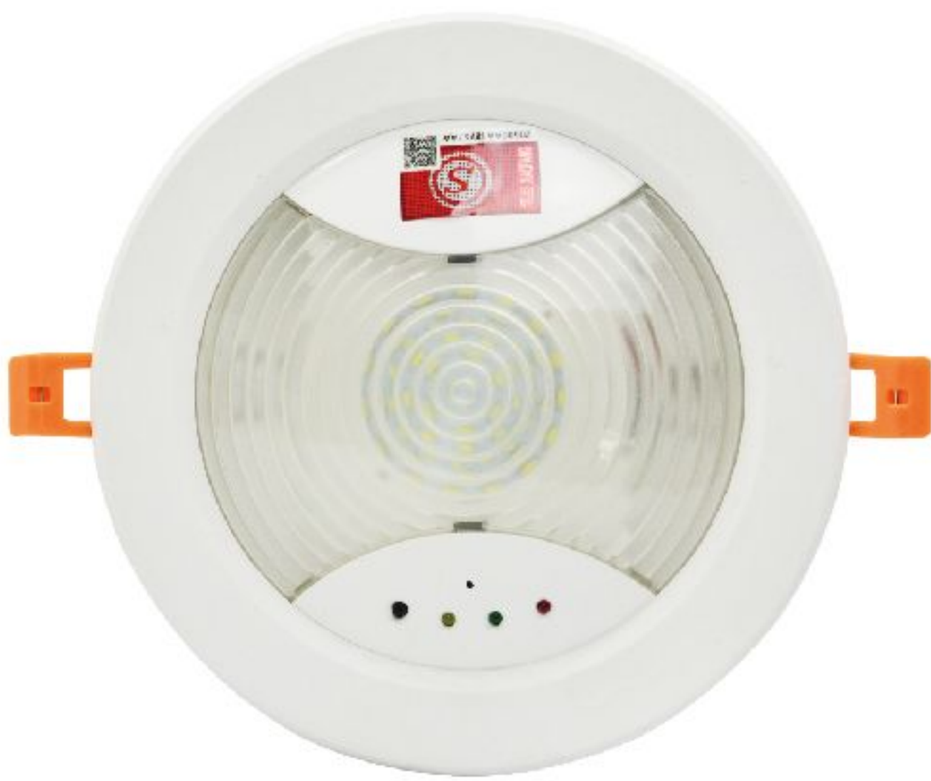
YG-ZLZD-E3W-1411 订货号：YG-14111 产品尺寸：Φ180x39mm 开孔尺寸：Φ160mm 主电功率：3W
